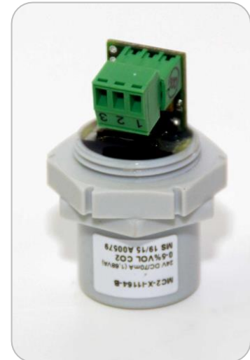
Wechsel-Sensoreinheit im Kunststoffgehäuse ohne Anschlusskabel
